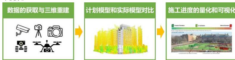
图 1 施工进度跟踪方法的基本流程
